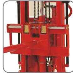
Snel-wissel systeem maakt het gemakkelijk om de speer te vervangen door een van de andere optionele extra's.
