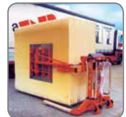
Spreidstand Logiflex met speciale grijparmen voor schuimrubberen blokken.
