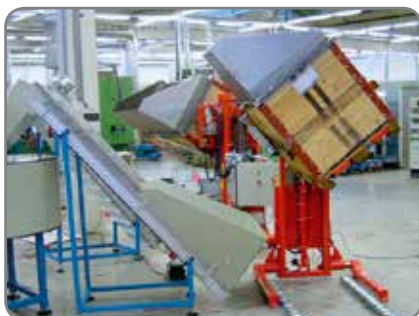
Logiflex met zijdelings kantelende vorken voor het heffen en ledigen van onderdelen in een productielijn.
