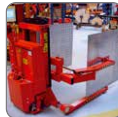
Spreidstand Logiflex met speciale grijparmen voor lichte materialen.
