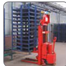
Elektrische Logiflex op afstand bediend door de computer, brengt lege paletten naar productielijn.
