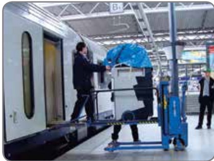
Logiflex met ramp om karren in en uit de trein te rijden.
