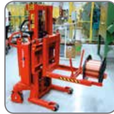
Logiflex met zijdelings instelbaar vorkenbord. De rol wordt op de speer van de machine geplaatst.
