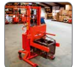
Logiflex met zijdelings kantelende vorken en speer om box te kantelen.
