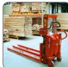
Logiflex met 3 extra lange vorken voor lange en zware lading.
