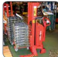
Logiflex met zeer korte vorken voor het behandelen van elektrische kasten.
